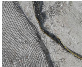
Gambar 9. Robek pada bagian overlay nets
